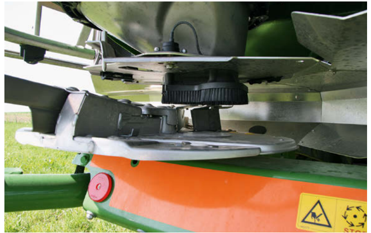
Der Dünger wird nahe des Mittelpunkts auf die Streuscheiben aufgebracht. Die auf Schlepp stehenden Schaufeln beschleunigen den Dünger.
