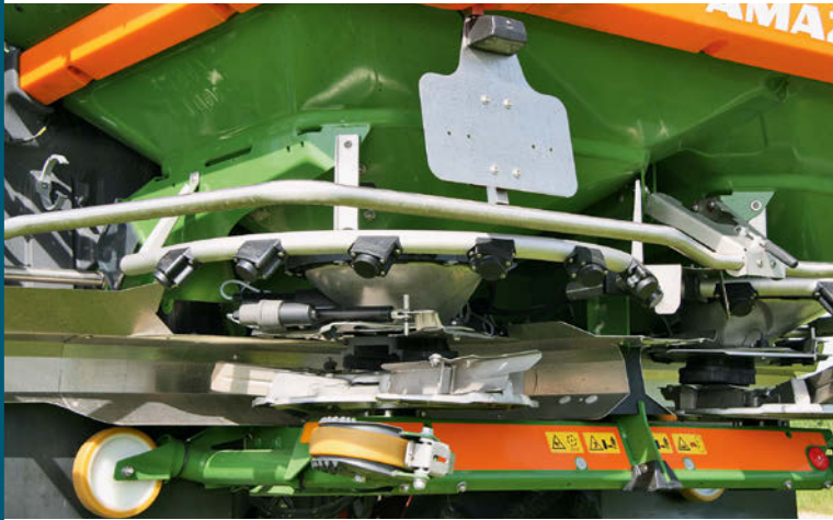
Argus Twin: Radarsensoren überwachen ständig das Streubild des Düngers und optimieren es über das Verdrehen des Einleitsystems.
